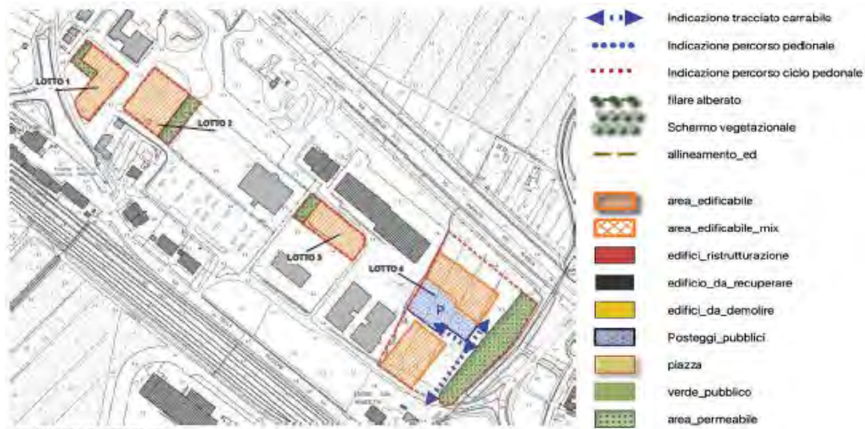
Figura 4-24: Schema grafico prescrittivo area di trasformazione AT3.05ID/PUC – COMPLETAMENTO DEL PUA AREA A SERVIZI STAZIONE FERROVIARIA
