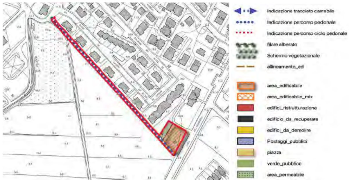
Figura 4-17: Schema grafico prescrittivo area di trasformazione AT3.01PUC – LOTTO RESIDENZIALE IN VIA DELL'AEROPORTO
