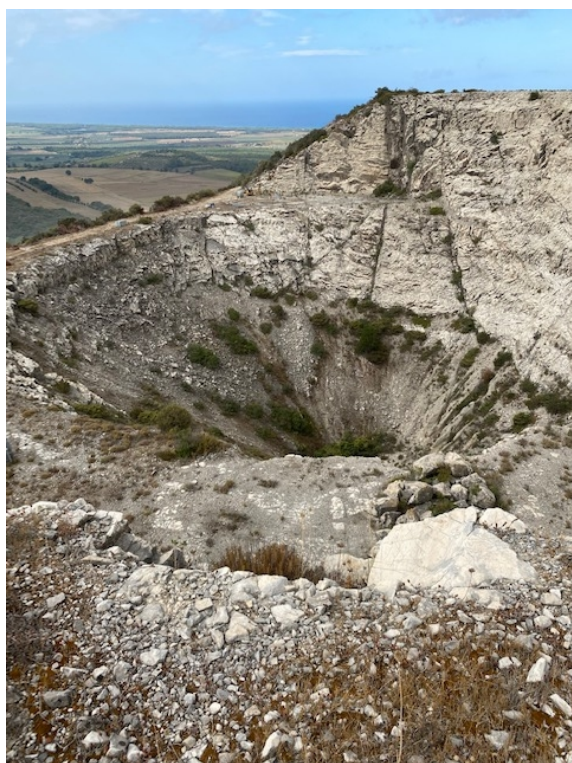
Nella foto uno dei Fornelli, profondi "imbuti" che rappresentano un raro esempio di questa tecnica di estrazione
